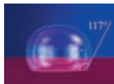
Ryc. B. Kropla wody na powierzchni niezwiązanej masy poliwinylsiloksanowej. Początkowo masy poliwinylsiloksanowe wykazują charakterystykę hydrofobową 1
